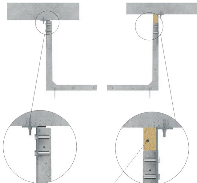
werkseitig aufgebrauchter und abgedichteter Dämmstoff
