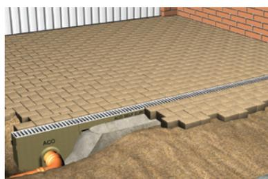
5. Oberflächenbelag anarbeiten. Wir empfehlen bei Pflasterbelägen die ersten Reihen in einem Mörtelbett zu verlegen.
