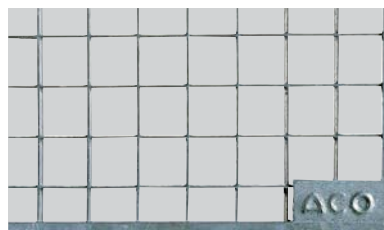
Maschenrost, Maschenweite 30 x 30 mm, begehbar bis 1,5 kN
