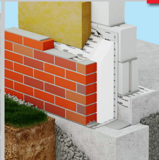
Im zweischaligen Mauerwerk auf Streifenfundament
