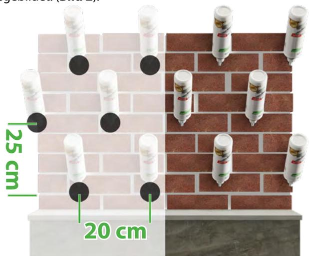
Abb. 2 Bohrlochschemata Flächensperre
