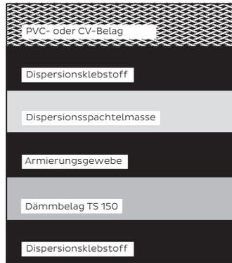
Belastungsgruppen muss mit Armierungsgewebe 100 und Zwischenspachtelung gearbeitet werden.
