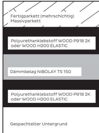
mit den Polyurethanklebstoffen oder Hybridklebstoffen, z. B. WOOD P918 2K bzw. WOOD H200 ELASTIC unter Einsatz der Spachtelzahnung B 3. Bei Verlegung von Stab- und Fertigparkett mit NIBOLAY TS 150 als Entkopplungsmatte auf Trockenestrichelementen bitte Rücksprache mit der Bostik Bautechnik halten.
