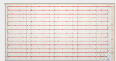
Verlegung der Heizrohre (16 mm)
