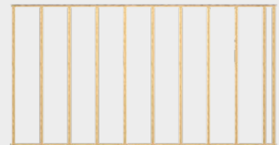
Achsabstand Unterkonstruktion max. 500 mm
