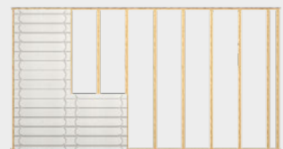
Montage der Therm25 in Unterkonstruktion (Schrauben 40 mm oder Klammern 50 mm)
