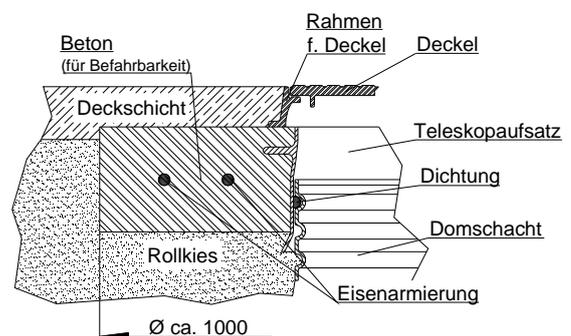
**Auftretende Lasten dürfen auf keinen Fall direkt auf den Tank übertragen werden.**
