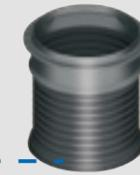
Die Domschacht-Verlängerung (Ø 62 cm) ist stufenlos teleskopierbar/kürzbar und für den frostsicheren Einbau geeignet. Sie ist zudem um 5° neigbar. Damit können Sie Ihre Tankabdeckung komfortabel und millimetergenau an Ihre Geländeoberfläche anpassen.
