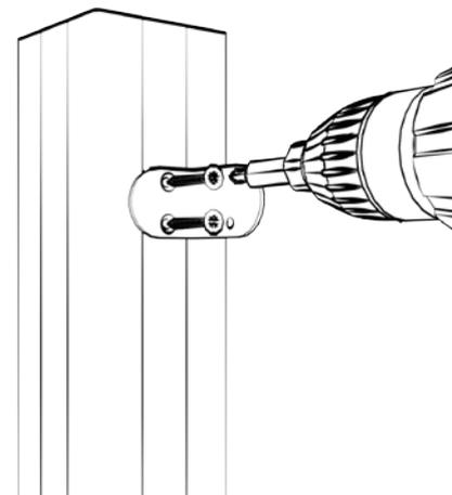
3b | Die Befestigungswinkel mit den mitgelieferten Schrauben am Pfosten befestigen. Die Schraublöcher mit einem 3 mm Bohrer vorbohren!
