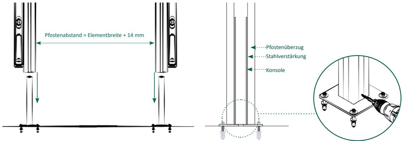
2a | Ausrichtung der Konsolen bei aufgesteckten Pfosten, danach aufdübeln. Der Pfostenüberzug und die Stahlverstärkung schließen nach dem Aufsetzen des Pfostens bündig ab.\*
