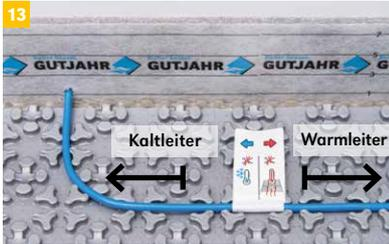
Der muffenlose Übergang zwischen Kaltleiter und Warmleiter ist genau gekennzeichnet und muss in der IndorTec® THERM-E Matte verlegt werden. Dieser Übergang ist so zu verlegen, dass der Warmleiter immer in der IndorTec® THERM-E Matte überspachtelt wird.
