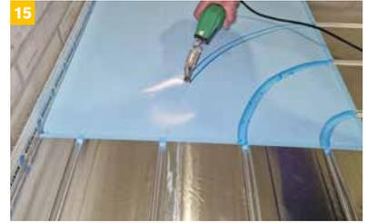
15 Beim Einsatz des Geräts darauf achten, dass die Führungsplatte mit Tiefeneinstellung immer mit der ganzen Fläche auf dem zu bearbeitenden Material aufliegt. Hierfür wird eine Nutschneide mit Ø 16 mm verwendet.
