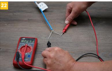
Vor Anschluss des Kabels an den Thermostat ist erneut der Gesamtwiderstand des Heizkabels gemäß Abnahmeprotokoll zu überprüfen und zu protokollieren.
