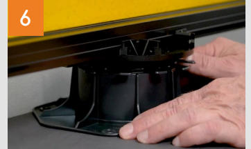
Ausrichten der Schienen durch Einstellen der Terrassenlager. Mit den Terrassenlagern kann ein Gefälle von bis zu 8 % ausgeglichen werden.
