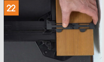
Einsatz der Bohrmarkierschablone
