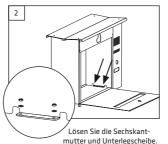
Bewahren Sie die Scheiben und Muttern auf. / Loosen the hexagon nut and washer. Keep the screws and nuts.
