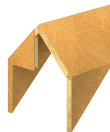
Satteldachgaube mit Giebelelement
