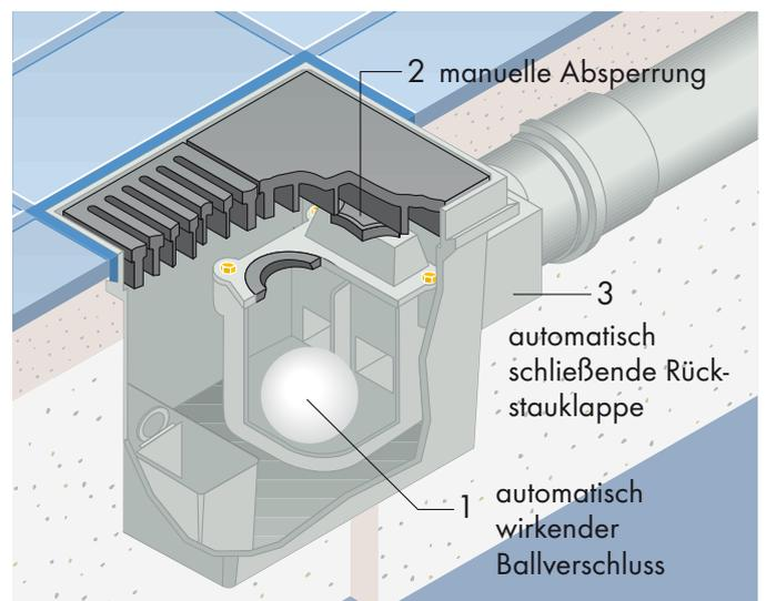
Verhindert das Zurückfließen von Abwasser bei Rückstau in der Kanalisation. Der Marley Kellerablauf mit Dreifachrückstauverschluss ist ein von der Prüfbehörde genehmigtes Markenerzeugnis, das einer laufenden Güteüberwachung nach DIN EN 13564 und DIN EN 1253 unterzogen wird.
