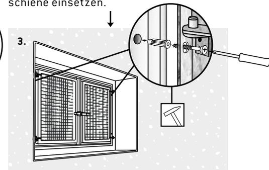
3. Fensterrahmen links und rechts mittels Dübelhülse und Schraube in Öffnung an der Zarge fixieren.
