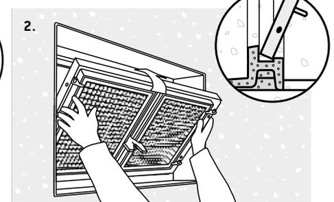
2. Stahlfenstereinsatz unten in Fixierschiene einsetzen.
