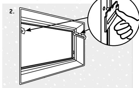
2. Kippscheren links und rechts in Öffnung an der Zarge drücken.
