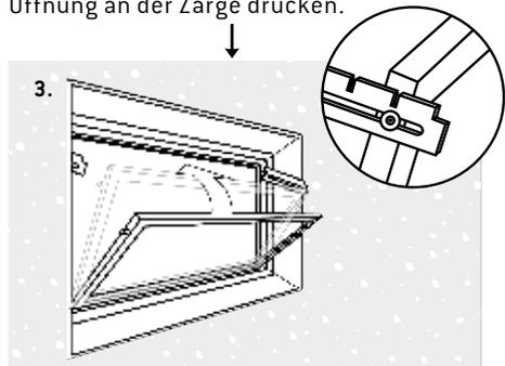
3. Fensterflügel unten in Fixierschiene an Zarge einsetzen, Fensterflügel in Kippscheren einhängen.
