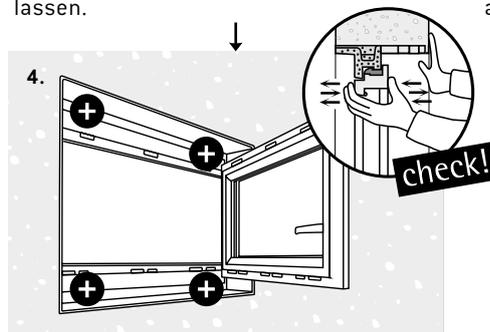
4. Fensterflügel öffnen und Einrastung der Click-Verbindung prüfen (> **Hinweis:** 2x unten, 2x oben, Höhe 80 cm und 100 cm zusätzlich links und rechts) um vollständige Fixierung der Fenster sicherzustellen.
