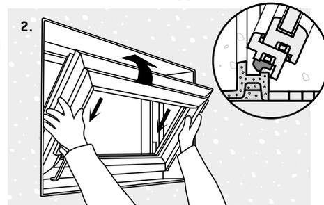
2. Fenstereinsatz unten in Fixierschiene einsetzen und nach unten drücken.
