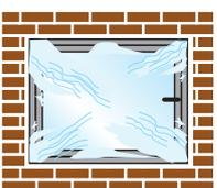
Bitte decken Sie bei Putzarbeiten rund um das Fenster Glas und Rahmen schützend mit Folie ab. Die Schutzfolie auf dem Fenster darf für diese Arbeiten nicht verwendet werden. Zuletzt dichten Sie die Fugen zwischen Blendrahmen und Mauerwerk innen und außen mit Dichtmasse ab.
