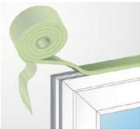
Das überkomprimierte Anfangs- bzw. Endstück abschneiden und das Band mit Hilfe der Selbstklebung aufkleben.
