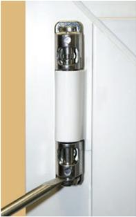
Montieren Sie den Fenstergriff auf dem Flügel und schrauben diesen fest. Anschließend hängen Sie den Flügel aus, indem Sie den Scherenlagerdorn herausziehen, bis die Feder einrastet. Nun den Flügel öffnen und herausheben.
