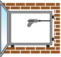
Verdübeln und verschrauben Sie das Fenster im Mauerwerk. Empf. Fensterrahmenschrauben (Siehe Fensterzubehör). Bei einer Außenmaßhöhe bis zu 123 cm, 3-fach in der Höhe. In der Höhe 4-fach, wenn das Außenmaß größer ist als 123 cm. Stemmen Sie die Klötze und Keile nun so ab, dass sie bündig mit dem Blendrahmen sind (**diese dürfen nicht entfernt werden**).
