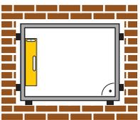
Stellen Sie den Blendrahmen in die Maueröffnung und unterlegen Sie diesen mit Klötzen und Keilen. Richten Sie nun das Fenster mit der Wasserwaage waagrecht und senkrecht aus (**bitte die Diagonale prüfen**).
