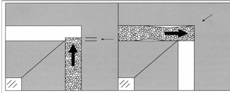
Das Fugenband darf unter keinen Umständen um Ecken herumgeführt werden und soll mit einer Überlänge von 1 cm pro m Fuge abgeschnitten werden. Das Fugenband ist versehen mit einem Träger in der Leimschicht, wodurch Überdehnung vermieden wird. Das Band soll ohne Dehnung montiert werden. Bei Anschlüssen von dem Fugenband in langen Fugen das Band stumpf stoßen (Übermaß in der Länge).
