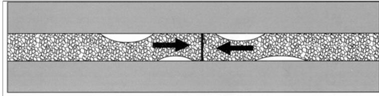
Das vertikale Fugenband, bei der Abdichtung von Kreuzfugen in einer schon bestehenden Fassadenkonstruktion, durchgehend montieren. Das horizontale Band stauchen (Übermaß in der Länge).
