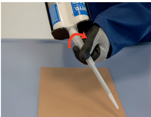
Material abwischen und Statikmischer KWM10, KWM18K oder RWM14G aufschrauben
