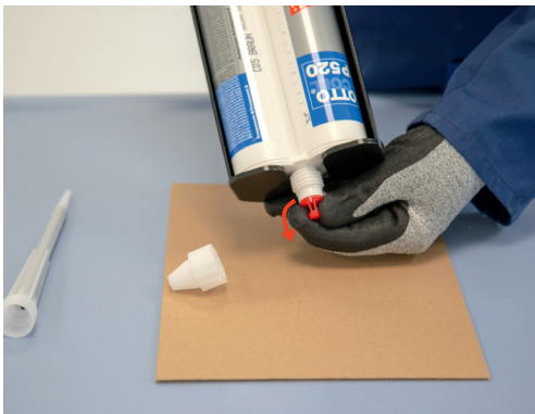
Einlegen der Kartusche in die Pistolenschale, Schutzkappe abschrauben und Stofen entfernen
