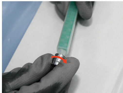
Gewindeaufsatz bis zum Anschlag auf Statikmischer schrauben
