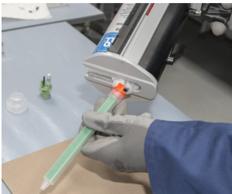
Material abwischen und Statkmischer aufsetzen
