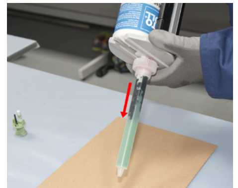
Befüllen des Statkmischer mit Klebstoff und Homogenität der Mischung prüfen (siehe Verarbeitungsbegleitende Qualitätskontrollen 2K-Produkte)
