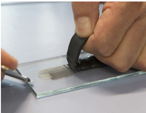
-> Abziehen der Klebstoffraupe und Beurteilung des Bruchbildes! Wenn es zu einem Kohäsionsbruch im Klebstoff kommt ist die Haftung zum Substrat einwandfrei.
