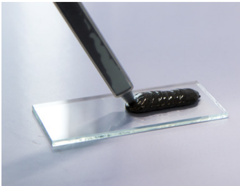
Auftragen des Klebstoffes
