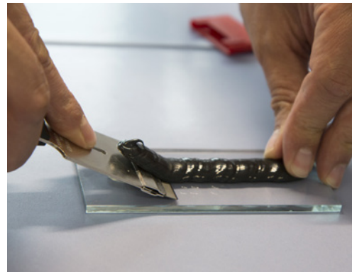
Einschneiden zwischen Klebstoff und Glasscheibe
