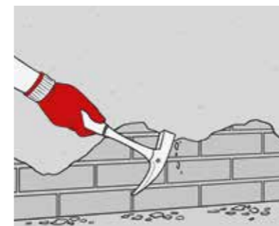
1. Losen Putz entfernen Entfernen von losen und kontaminierten Putzbereichen. Die Fläche muss sauber und trocken sein.
