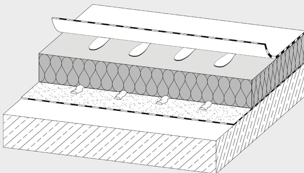
Hoch verdichtete Steinwolle-Dachdämmplatte mit oberseitiger Mineralvlieskaschierung.
