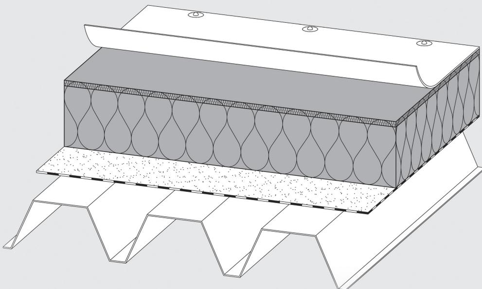
Steinwolle-Dachdämmplatte\* mit verbesserten Wärmeschutzeigenschaften und integrierter Zweischichtcharakteristik. Aufgrund ihrer hoch verdichteten, lastverteilenden Oberlage bietet sie eine verbesserte Widerstandsfähigkeit gegen mechanische Beanspruchungen.
