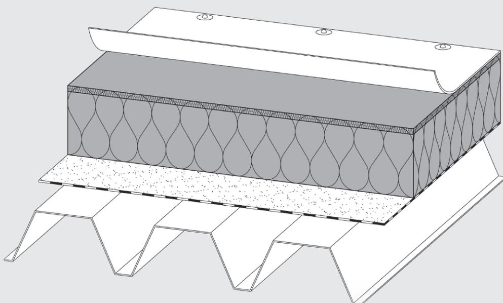
Steinwolle-Dachdämmplatte mit hoher Punktbelastbarkeit durch integrierte Zweischichtcharakteristik. Aufgrund ihrer hoch verdichteten, lastverteilenden Oberlage bietet sie eine verbesserte Widerstandsfähigkeit gegen mechanische Beanspruchungen.
