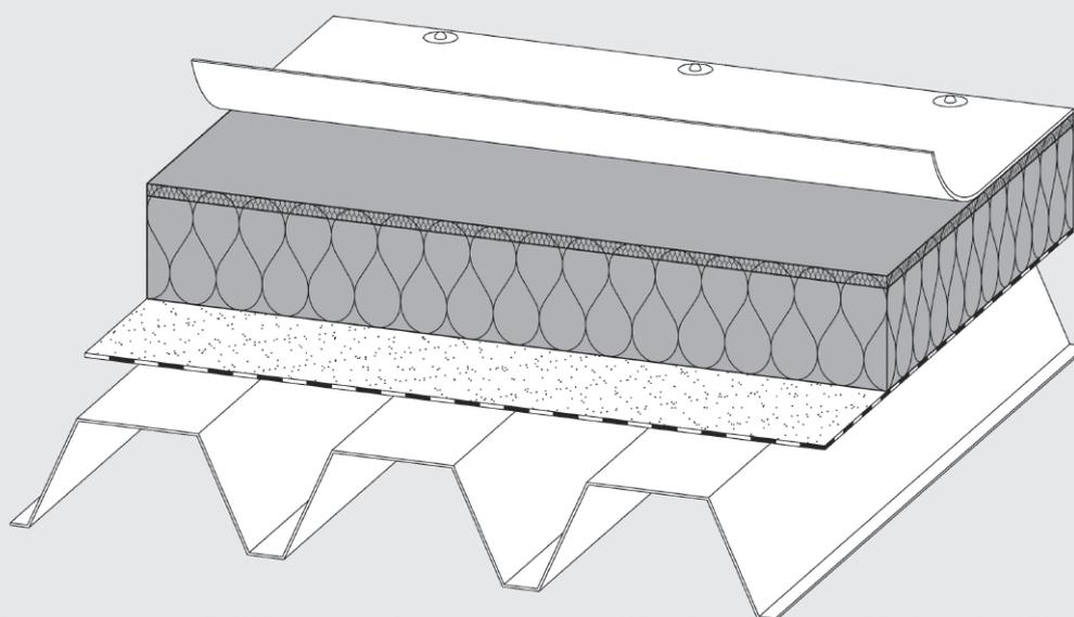
Hoch wärmedämmende Steinwolle-Dachdämmplatte mit erhöhter Punktbelastbarkeit durch integrierte Zweischichtcharakteristik. Aufgrund ihrer hoch verdichteten, lastverteilenden Oberlage bietet sie eine verbesserte Widerstandsfähigkeit gegen mechanische Beanspruchungen.
