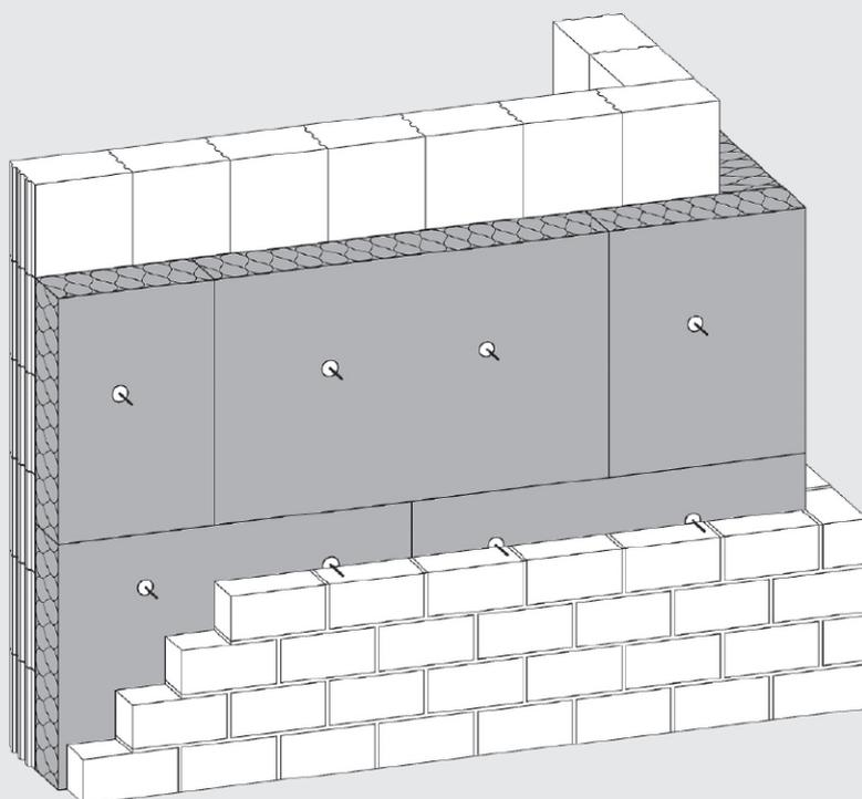
Formstabile Steinwolle-Dämmplatte für die Kerndämmung im zweischaligen Mauerwerk.
