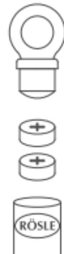
Drehen Sie den Aufhängering auf dem Griff im Uhrzeigersinn erneut leicht fest und Ihr Gourmet-Thermometer ist sofort einsatzbereit. Die Temperatur wird nach dem Batteriewchsel in Grad Celsius angezeigt.
