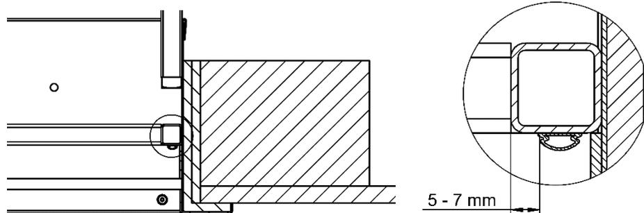
Gummidichtung an alle **vier** Stahlprofile Kleben.
