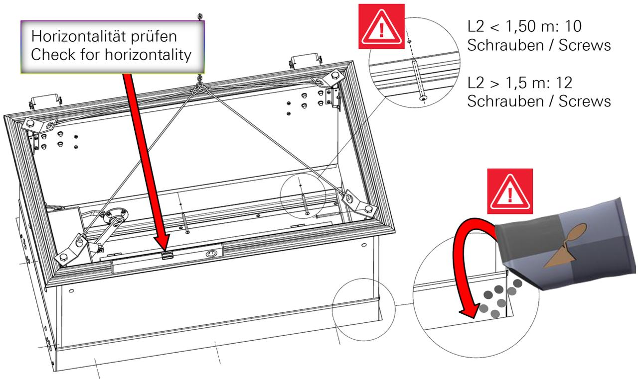
Den Spalt zwischen Luke und Decke mit Brandschutzmörtel EN 998-2, Klasse M10 füllen!
