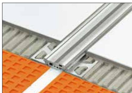
Schlüter-DILEX-BT ist ein Bautrennfugenprofil aus Messing oder Aluminium mit seitlicher Gelenkanbindung des ineinander verschiebbaren Mittelteils. Somit ist eine dreidimensionale Bewegungsaufnahme möglich (siehe Produktdatenblatt 4.20).
