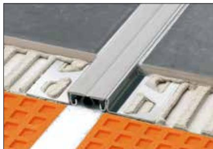
Schlüter-DILEX-KSBT ist ein Bautrennfugenprofil mit Kantenschutz, bestehend aus seitlichen Befestigungsschenkeln aus Messing, Aluminium oder Edelstahl, die mit einer 20 oder 30 mm breiten Bewegungszone aus weichem Kunststoff verbunden sind (siehe Produktdatenblatt 4.19).
