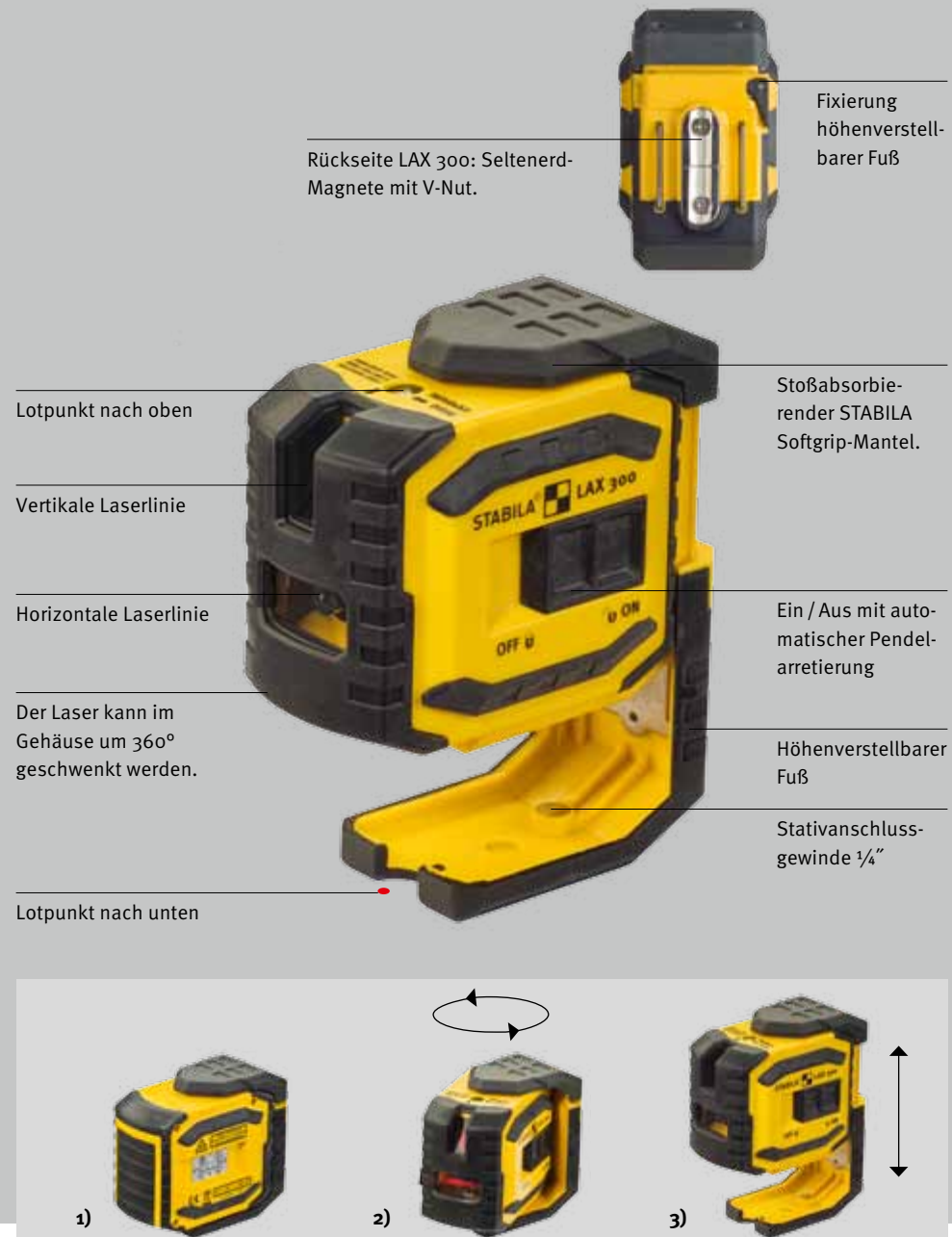
1) Parkstellung. 2) Gehäuse im U-Griff um 360° schwenkbar. 3) Durch den ausziehbaren Fuß ist der Laser höhenverstellbar.
