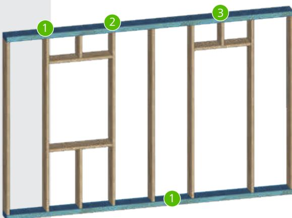
Im Standardsortiment sind STEICO *GLVL R* Querschnitte speziell für höchste Belastungen als Schwelle/Rähm bemessen. Im Vergleich zu Vollholz können sie beim Einsatz als Schwelle mit ihrer
