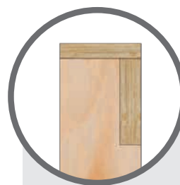
Ausglinkter Wandständer mit durchgehendem Rähm
