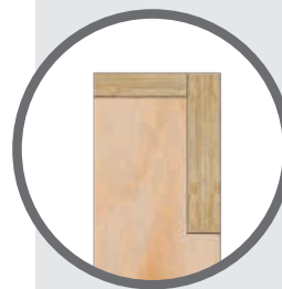
Ausglinkter Wandständer mit durchgehendem Fenstersturz und Rähm
