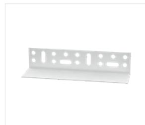
Kunststoffprofil für die wärmebrückenfreie Sockelausbildung bzw. zum Aufsetzen der untersten Dämmplatten. In Kombination mit dem Sockelprofil verwendbar. Befestigung z.B. mit dem Schlagdübel.
