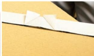
**4.** Den schmalen Liner nach hinten klappen und die Ecken zu einem Dreieck aufklappen
