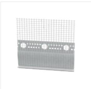
Das Blechanschlussprofil erlaubt den Anschluss von Putzflächen an aufgehenden Verblechungen, z.B. an Dachgauben, Garagen, Attika- und Sockelblechen. Die einzelnen Profilteile lassen sich wiederum mit Steckverbindern verformungssicher verbinden. Das Blechanschlussprofil wird mit
