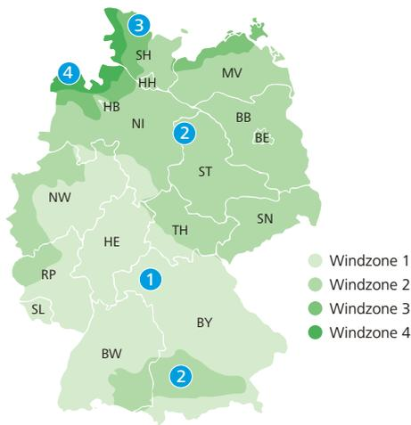
In die Ermittlung der Winddruck- und Sogkräfte ( $w_e$ ) fließen der Böengeschwindigkeitsdruck ( $q$ ) und der aerodynamische Beiwert ( $c_{pe}$ ) ein.
