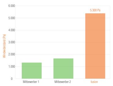
Die zertifizierte Windbeständigkeit ist mehr als viermal höher als bei Mitbewerberprodukten. Damit eignet sich Clearline Fusion auch für die exponiertesten Standorte
