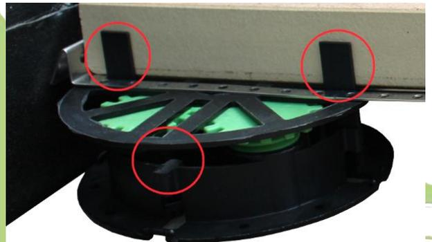
Abbildung 6: Anwendungsbsp. VOLFI-ZRV mit WAE-K. Für die Verlegung im Randbereich werden 2 gegenüberliegenden Fugenstege entfernt. Anschließend kann der Wandabstandhalter einfach in die I-Fuge des Stelzlagers eingelegt werden.
