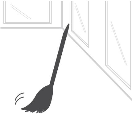
① Der Untergrund muss ausgehärtet, sauber, trocken und staubfrei sein.
