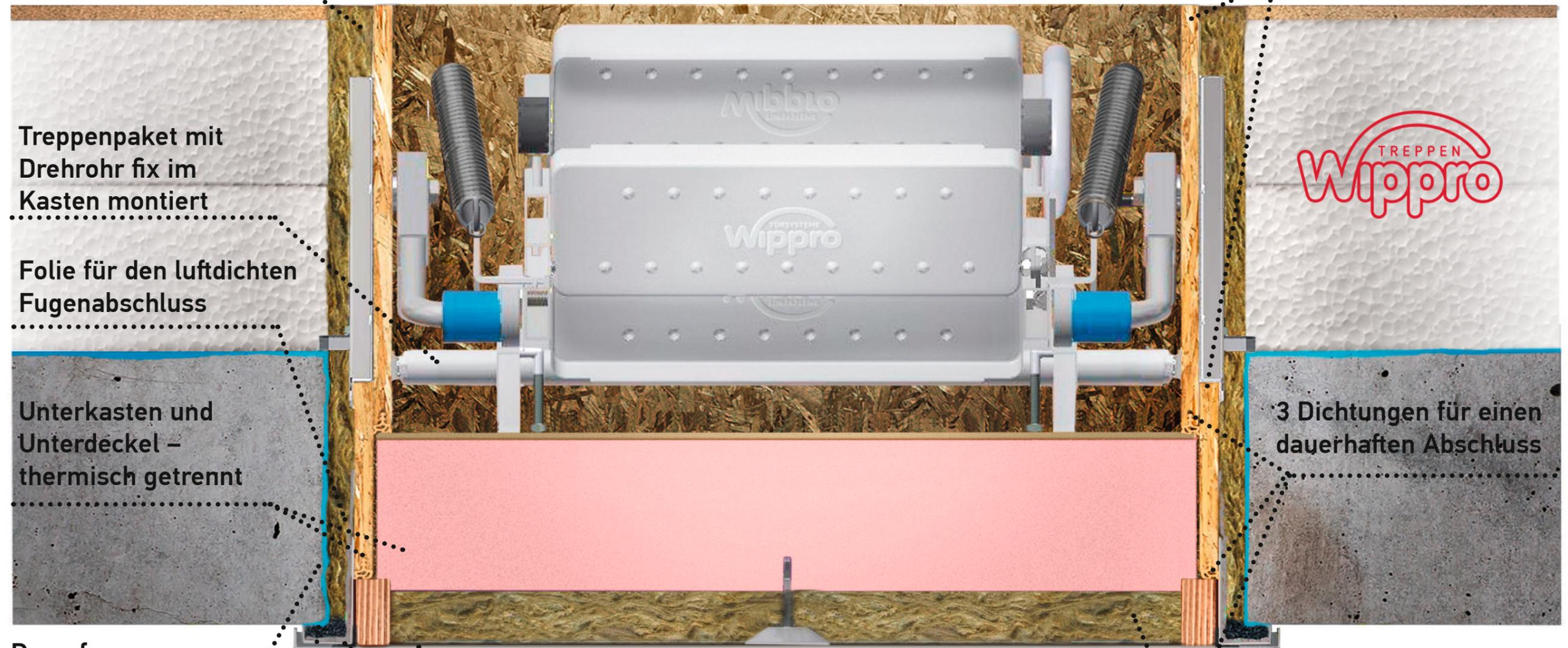
Treppenpaket mit Drehrohr fix im Kasten montiert
