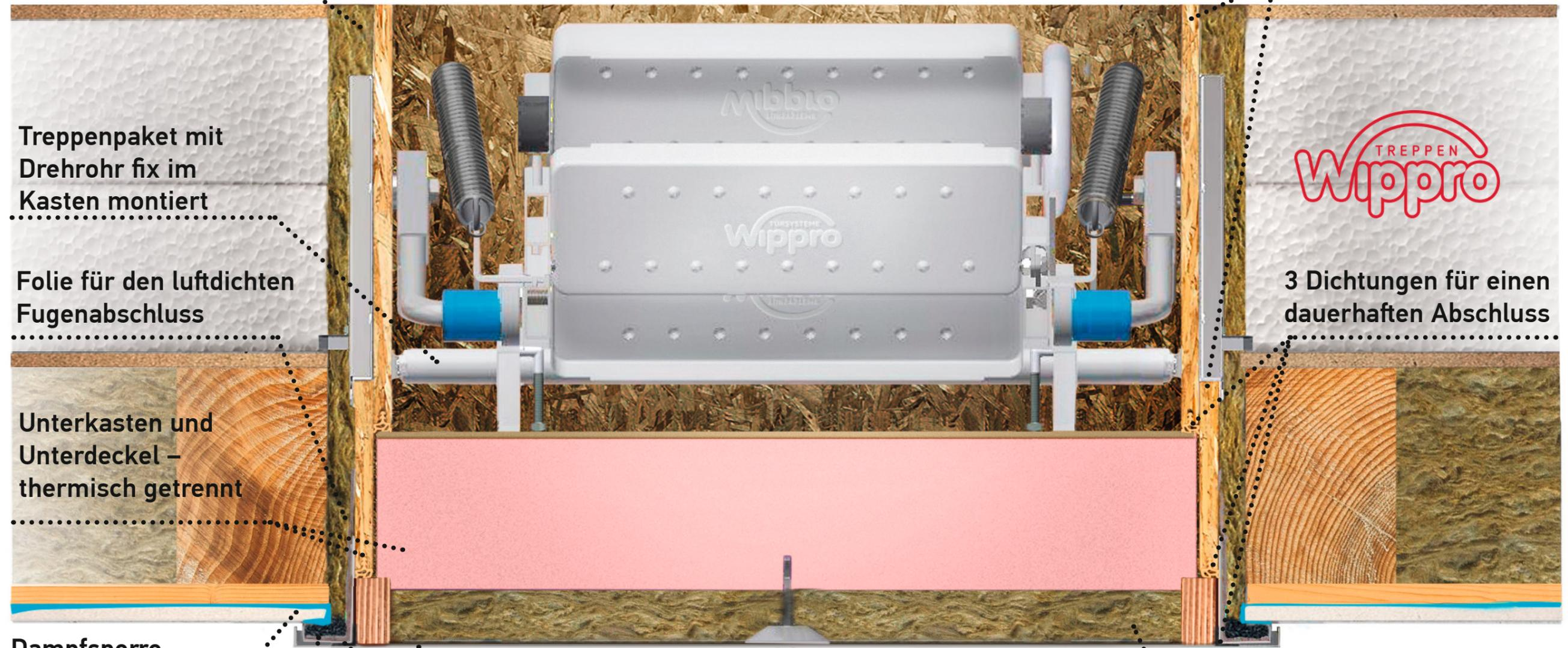
Treppenpaket mit Drehrohr fix im Kasten montiert
