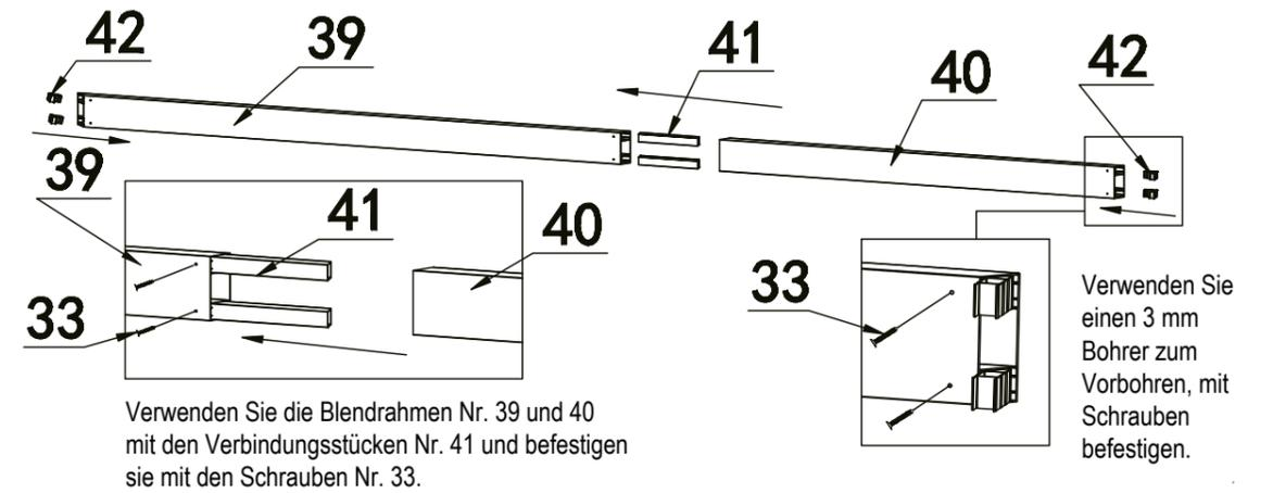
Verwenden Sie die Blendrahmen Nr. 39 und 40 mit den Verbindungsstücken Nr. 41 und befestigen sie mit den Schrauben Nr. 33.
