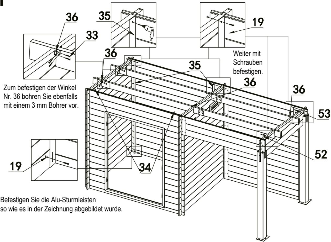
Zum befestigen der Winkel Nr. 36 bohren Sie ebenfalls mit einem 3 mm Bohrer vor.
