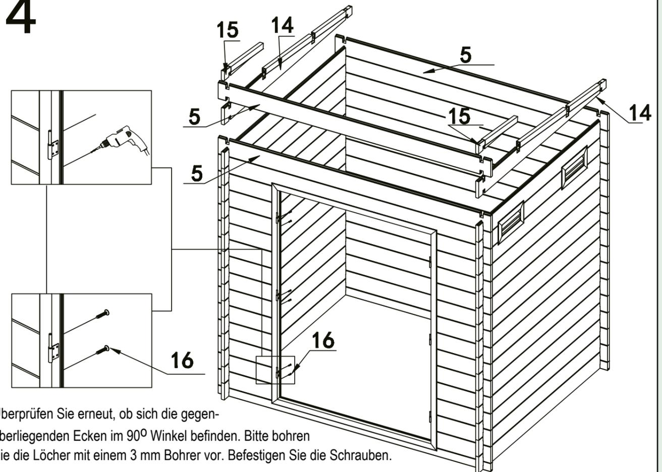
Überprüfen Sie erneut, ob sich die gegenüberliegenden Ecken im 90° Winkel befinden. Bitte bohren Sie die Löcher mit einem 3 mm Bohrer vor. Befestigen Sie die Schrauben.
