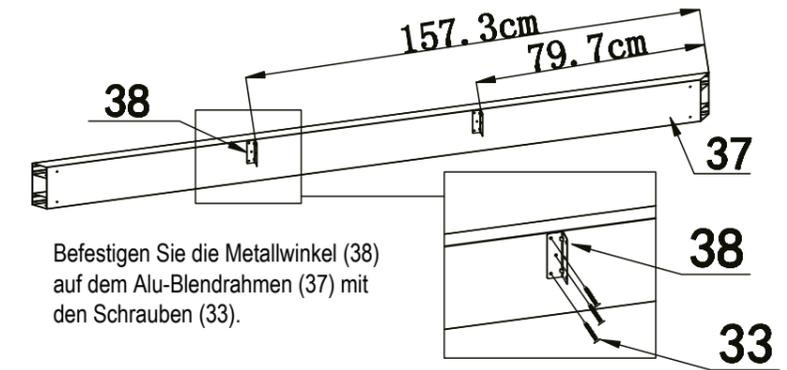
Befestigen Sie die Metallwinkel (38) auf dem Alu-Blendrahmen (37) mit den Schrauben (33).
