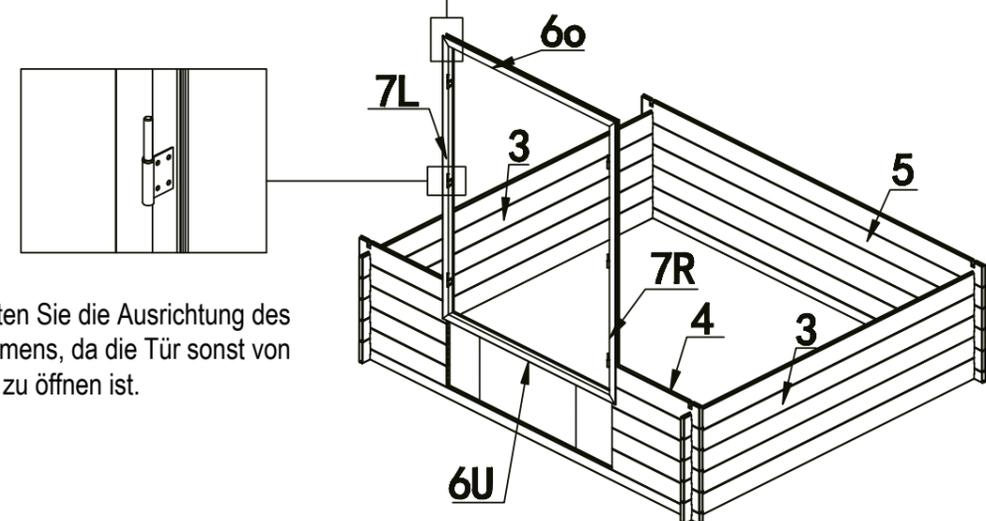
Beachten Sie die Ausrichtung des Türrahmens, da die Tür sonst von außen zu öffnen ist.
