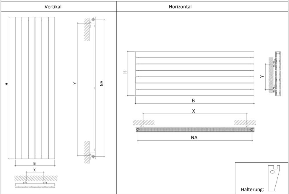
④ Für Heizkörper die mit Halterungshülsen an den fest angebrachten Zapfen montiert werden:
