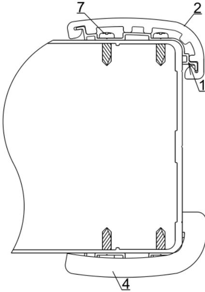
2. Stülpen Sie eine Seite des Kantenschutzes an die bereits am Bodenträger montierte Grundplatte. Danach die andere Seite indem Sie den Kantenschutz dehnen.
